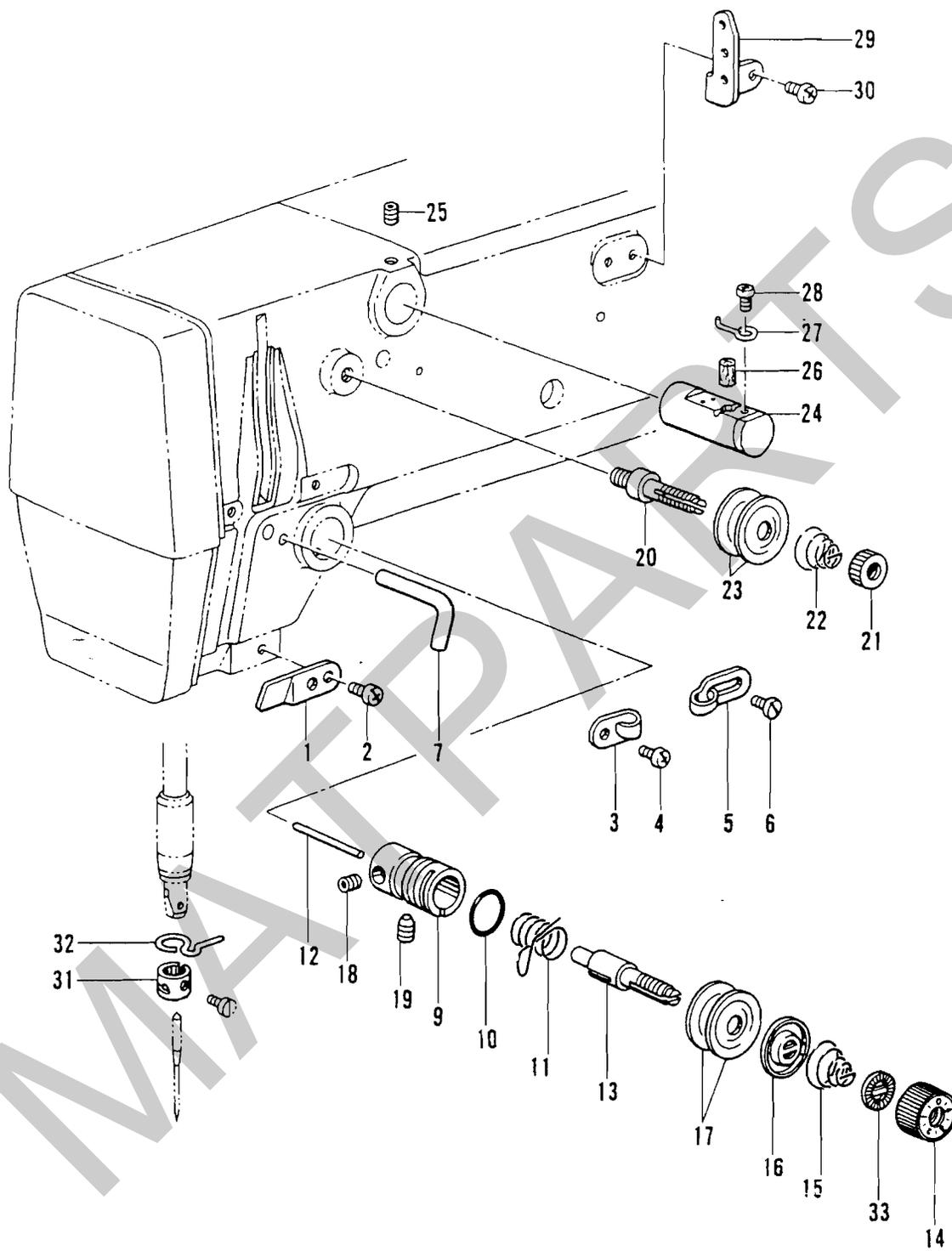
Mécanisme de l'enfilage / Mecanismo de la enhebrado
